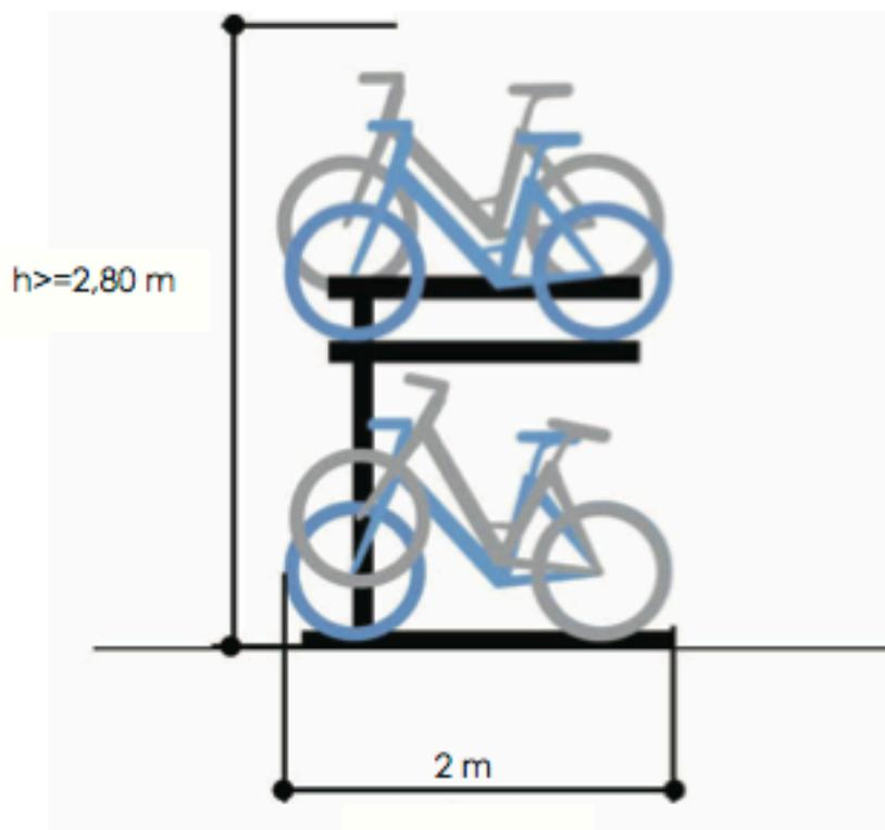
*Figure 14 : Rangement sur deux niveaux allié à une disposition resserrée*
