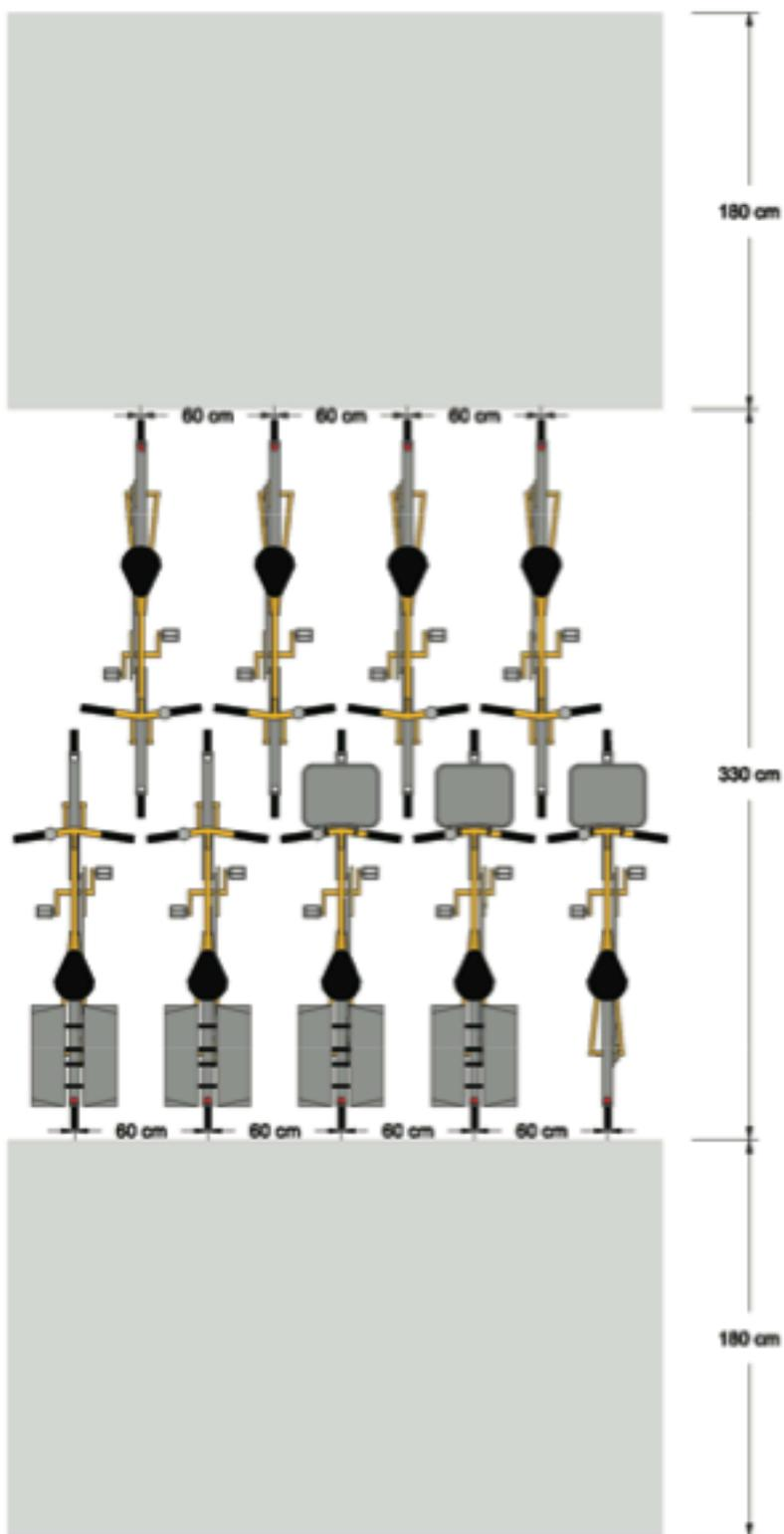
Figure 8 : Disposition avec recouvrement des roues avant
